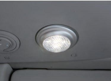
운전석 / 출입문 LED 램프
