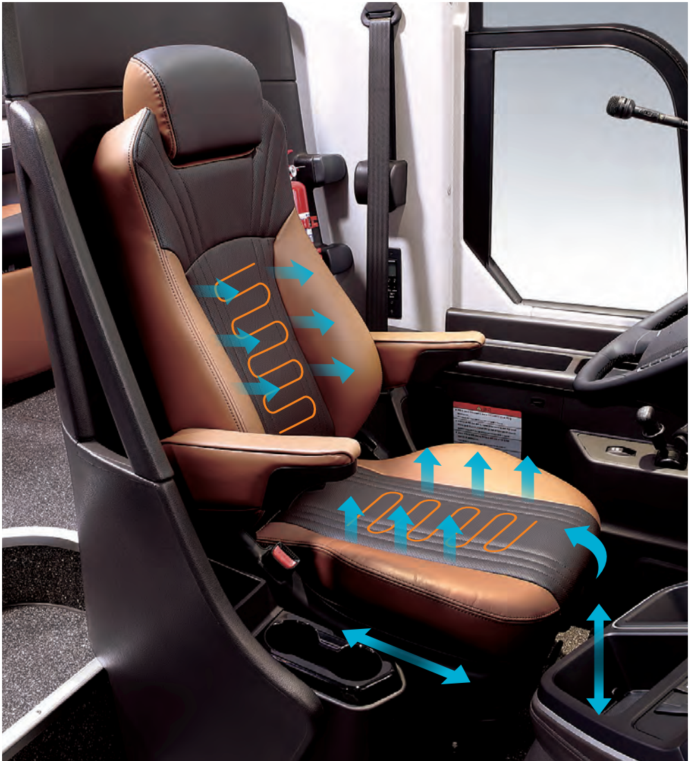
운전석 시트 (멀티펄션 시트, 천연가죽+통풍+열선) 상기 기능 포함 및 전동 팬을 이용하여 덕트를 통해 항균 처리 기능의 시트 쿠션과 등받이에 바람을 보내주어 시트 바닥과 등에 습기가 차는 것을 방지함으로써 쾌적한 착좌감을 제공합니다.
